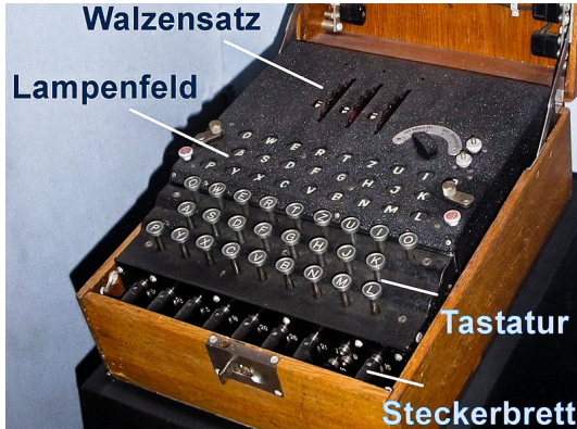
Abbildung: Die deutsche Rotor-Schlüsselmaschine Enigma (20. Jahrhundert). Quelle: wikimedia.org
